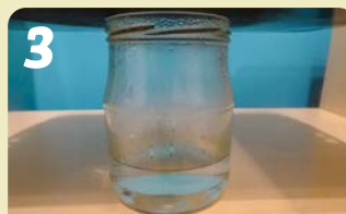
3 Vzduch uvnitř sklenice stoupá, led ho ochlazuje a vodní pára obsažená ve vzduchu se sráží na kapičky.
